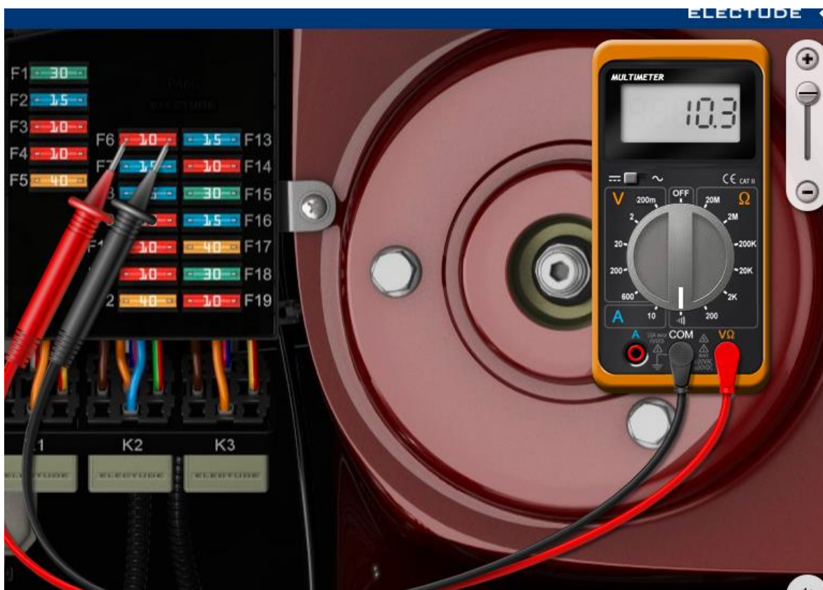
Ilustración 7.- Fusible "F6" con una lectura de continuidad extraña
