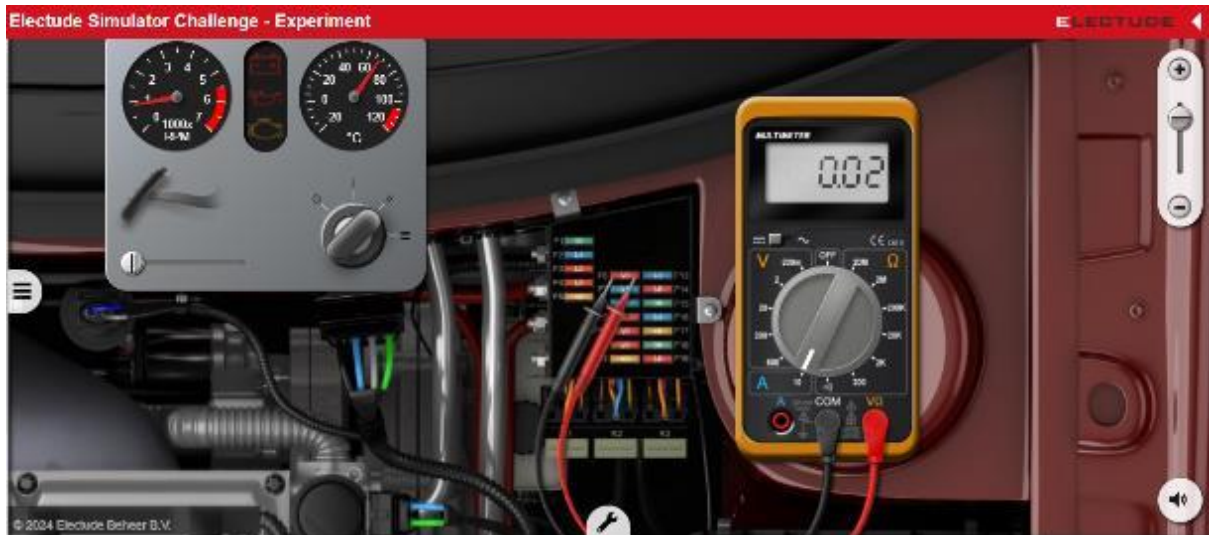
Figura 11. Medición de intensidad eléctrica.
