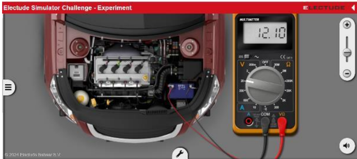
Figura 8. Medición de voltaje con el motor apagado.
