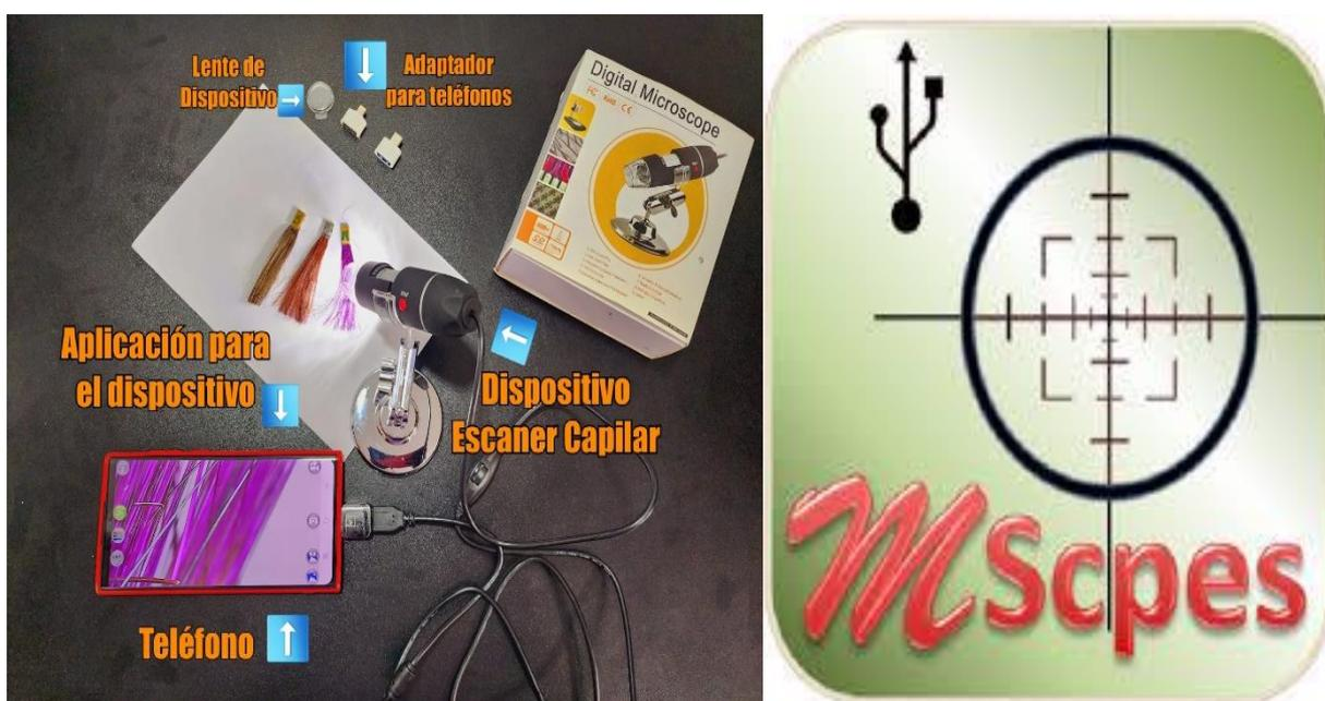
Figura 1. Elementos y aplicación del escáner capilar
