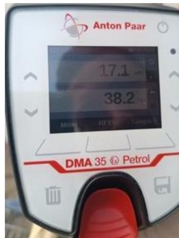
**Figura 2. Análisis del grado API del crudo del mono pozo**
