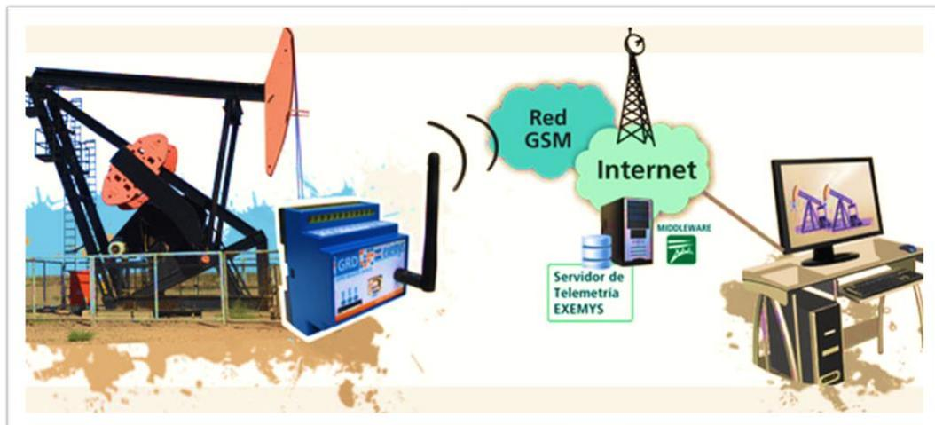
**Figura 4. Sistema remoto de monitoreo y control de un pozo petrolero**
