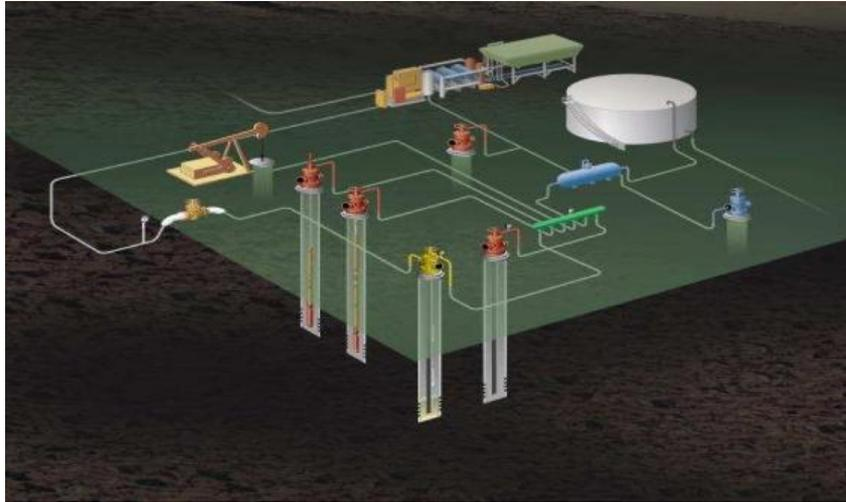
Figura 2. Proceso básico de recolección de crudo en una plataforma petrolera. (Fernández, 2017).
