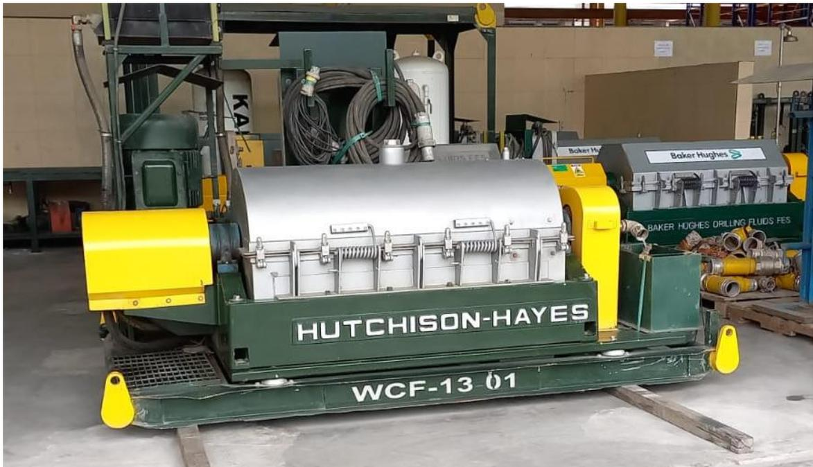
Figura 7. Centrifuga Decantadora H&H 5500
