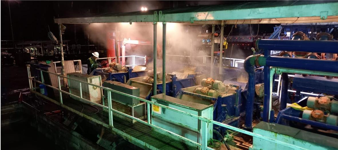
Figura 6. Sistema primario de Control de Sólidos
