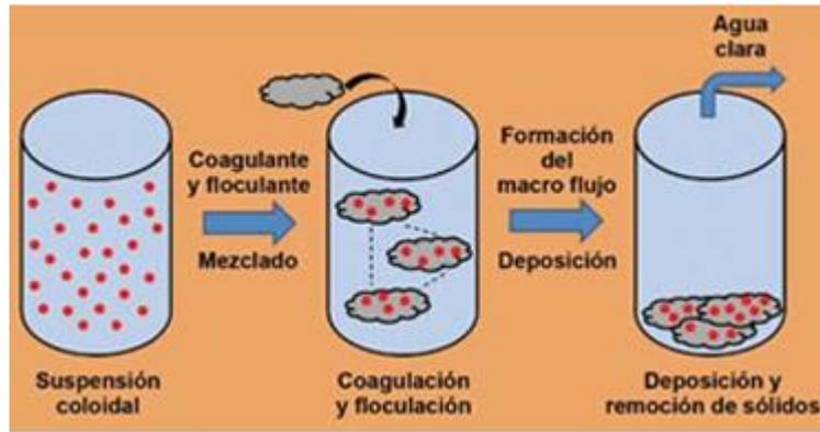
Figura 13. Mecanismo de Coagulación
