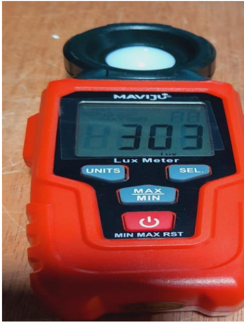
Medición del nivel de iluminación con el luxómetro teniendo como resultado 300lx
