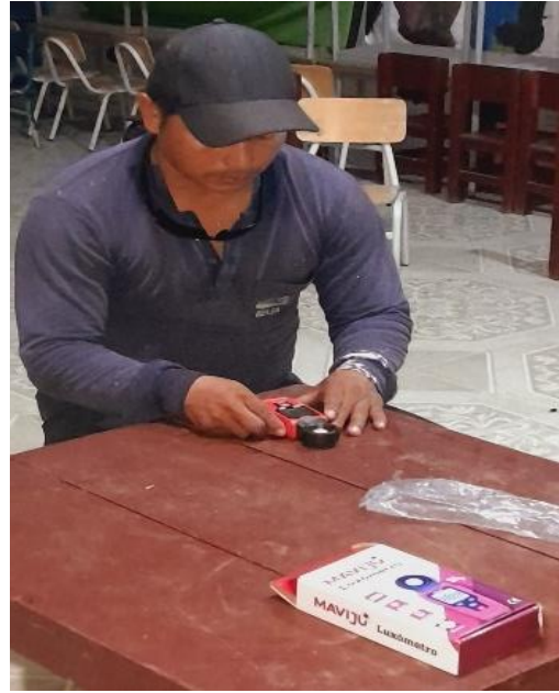
Medición del nivel de iluminación con el luxómetro teniendo como resultado 300lx
