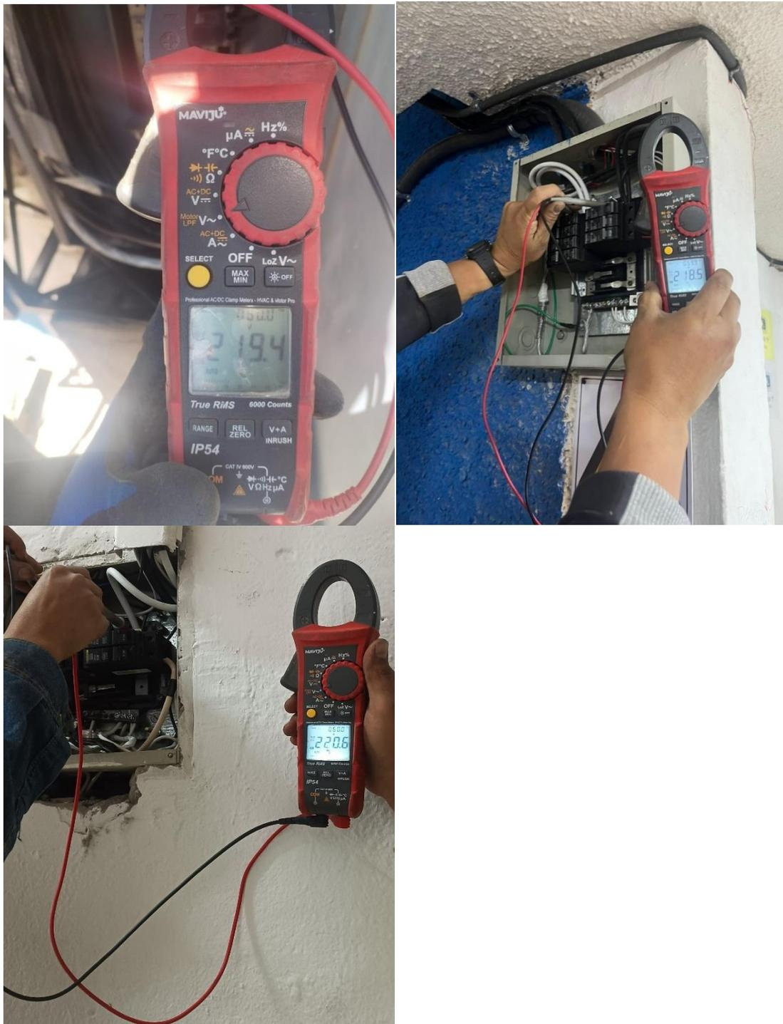
Figura 47: Revisión de voltajes
