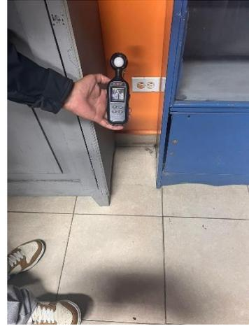
**FIGURE 43: MEDICIÓN DE LUMINOCIDAD**
