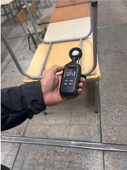
FIGURE 49: MEDICIÓN DE LUMINOCIDAD
