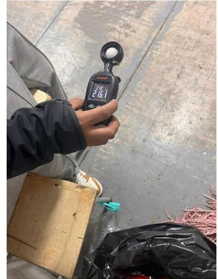
FIGURE 47: MEDICIÓN DE LUMINOCIDAD
