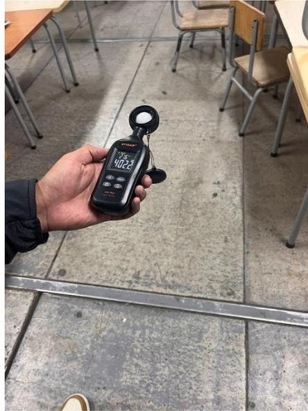
FIGURE 50: MEDICIÓN DE LUMINOCIDAD
