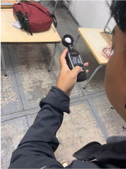
FIGURE 45: MEDICIÓN DE LUMINOCIDAD
