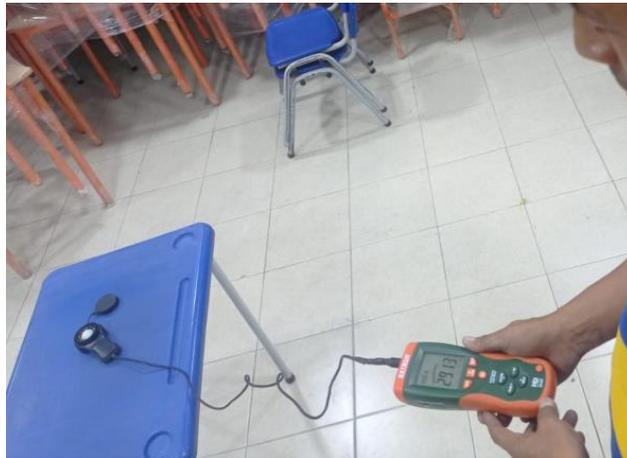
*Figura 48., Medición de luminosidad con luxómetro en el aula 1. Bloque I
