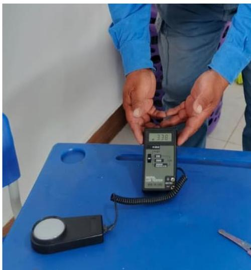
*Figura 51., Medición de luminosidad con luxómetro en el aula 7. Bloque I
