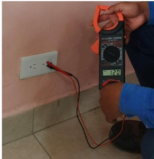
*Figura 57., Medición de voltaje en los tomacorrientes aulas 5 bloque1.*
