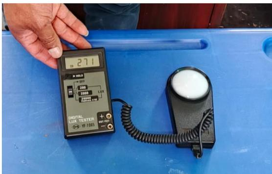
*Figura 54., Medición de luminosidad con luxómetro en el aula 3. Bloque2*
