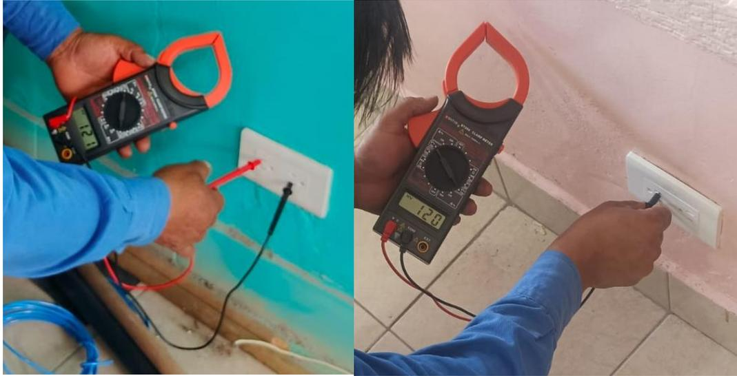
*Figura 58., Medición de voltaje en los tomacorrientes aulas 4 y 5 bloque.*
