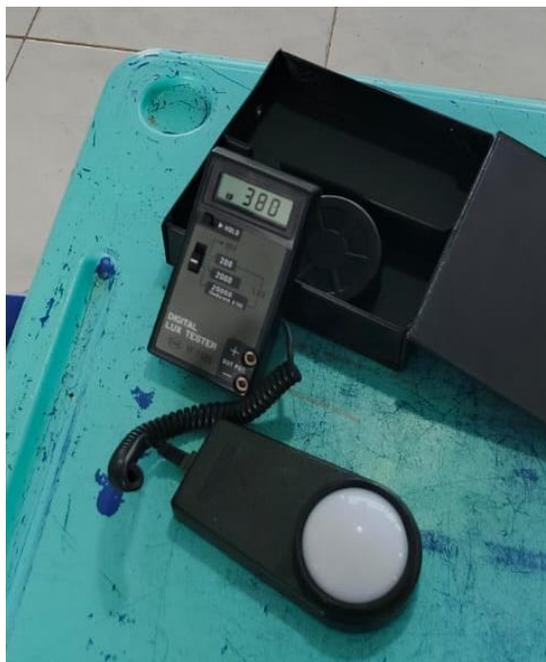
*Figura 52., Medición de luminosidad con luxómetro en el aula 1. Bloque2.
