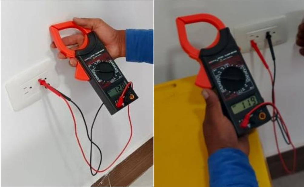
*Figura 56., Medición de voltaje en los tomacorrientes aulas 1 y 3 bloque1.*
