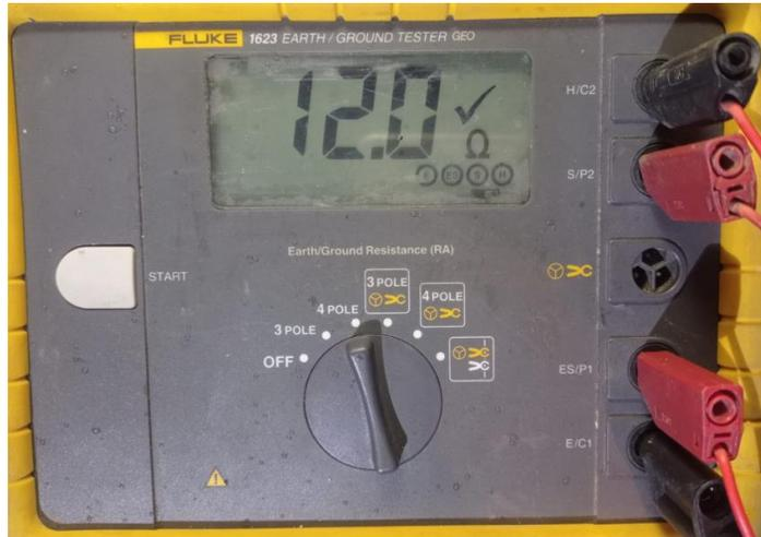
*Figura 59., Medición de resistencia en la puesta a tierra.*
