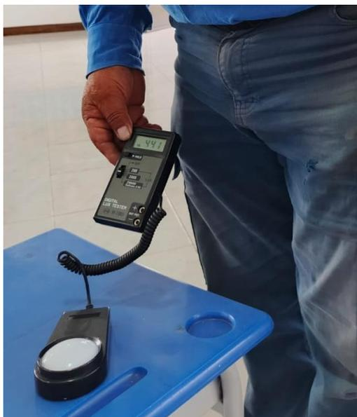
*Figura 50., Medición de luminosidad con luxómetro en el aula 5. Bloque I
