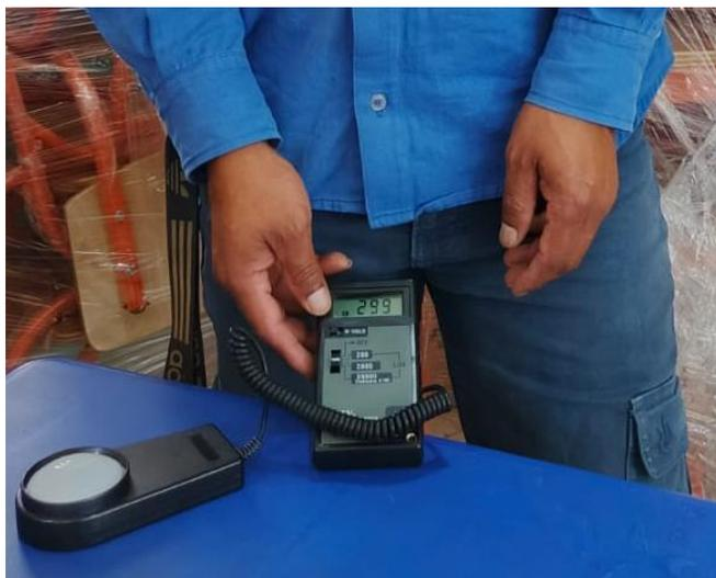
*Figura 53., Medición de luminosidad con luxómetro en el aula 2. Bloque2
