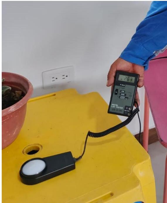
*Figura 49., Medición de luminosidad con luxómetro en el aula 3. Bloque I
