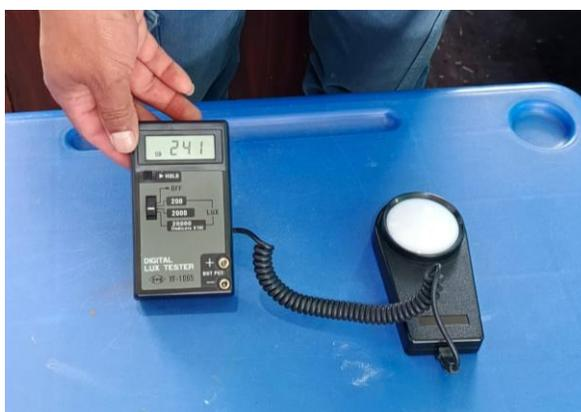
*Figura 55., Medición de luminosidad con luxómetro en el aula 4. Bloque 2*
