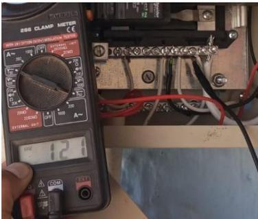
Nota: Medición de voltaje con multímetro Fuente: Auditoria propia.
