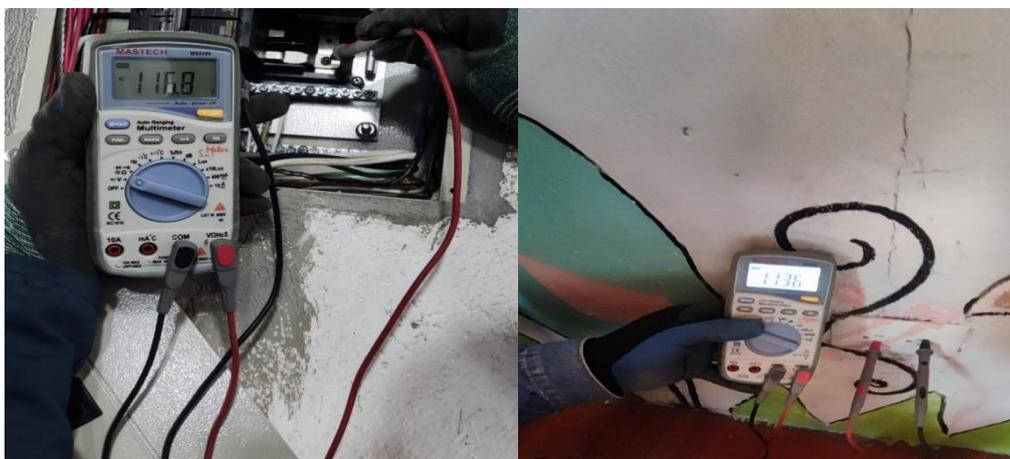
**Figura 39.** Imágenes de voltajes medidos tanto en barras de CC 1 y del Tomacorriente en el aula 8, tomadas en pruebas para verificar la caída de voltaje.
