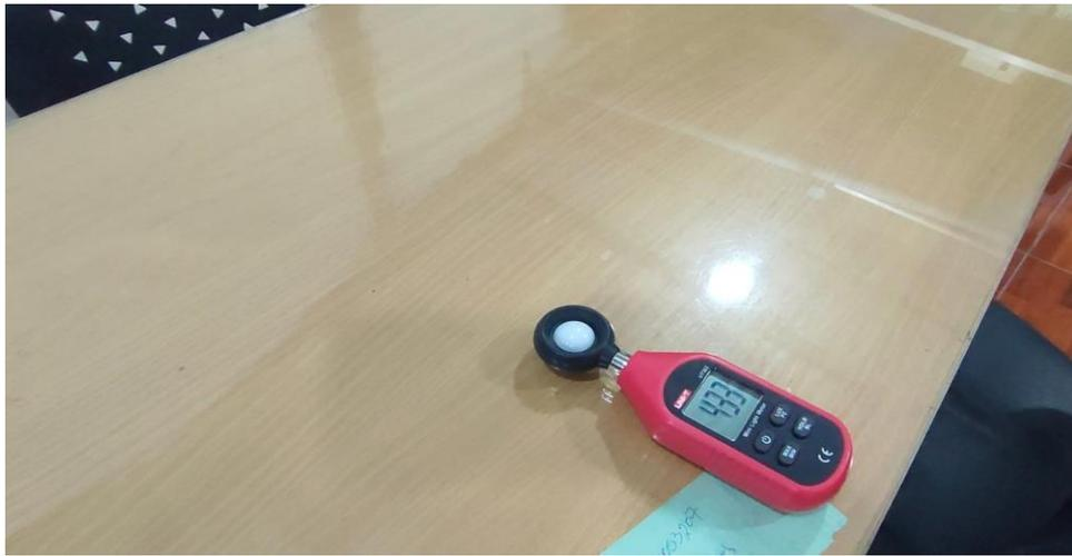
**Figura 40.** Medición del nivel de iluminación en el aula 1 valor de 433 Luxes.
