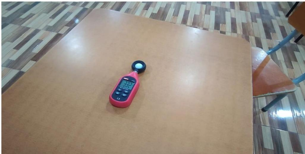
**Figura 41.** Medición del nivel de iluminación en el aula 3 valor de 332 Luxes.
