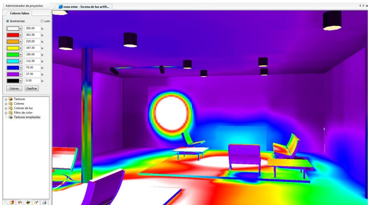
**Figura 15.** *Diseño luminotécnico Dialux*
