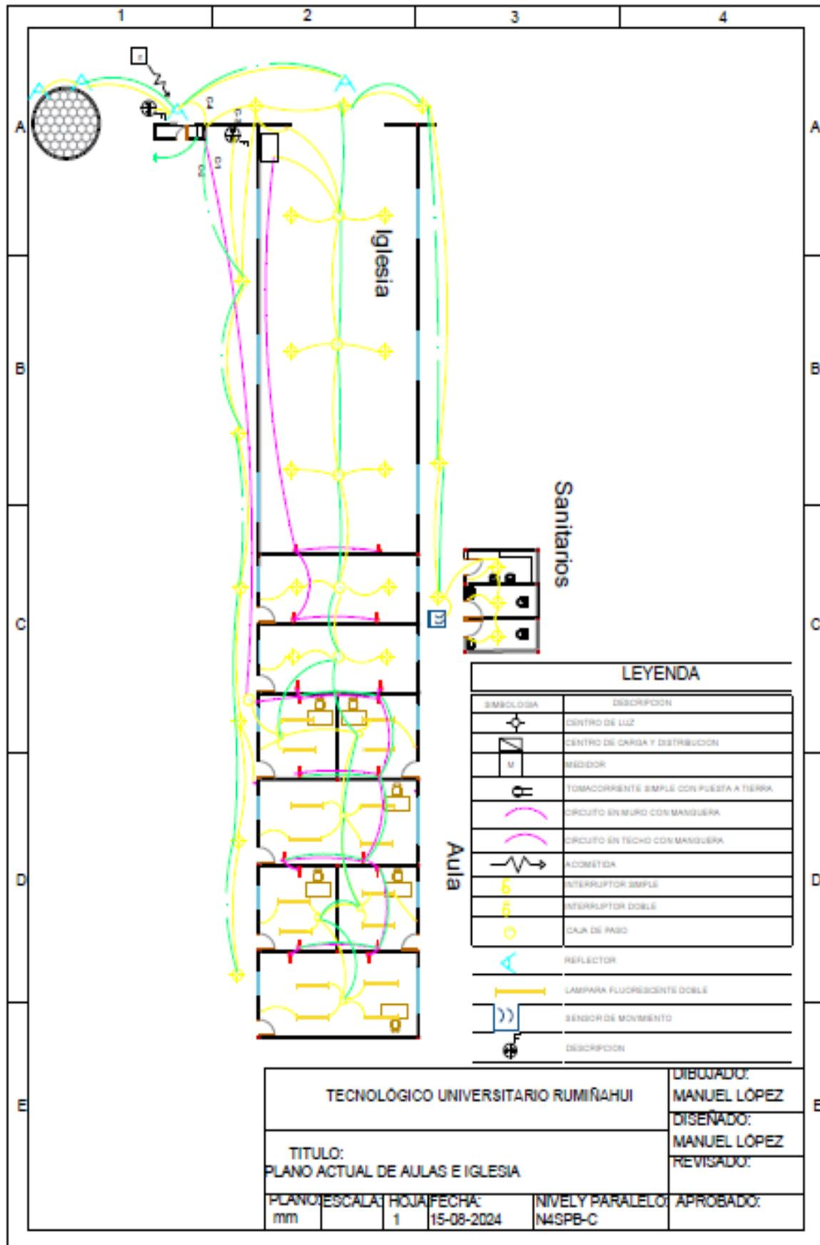
Figura 18. Plano del circuito eléctrico actual
