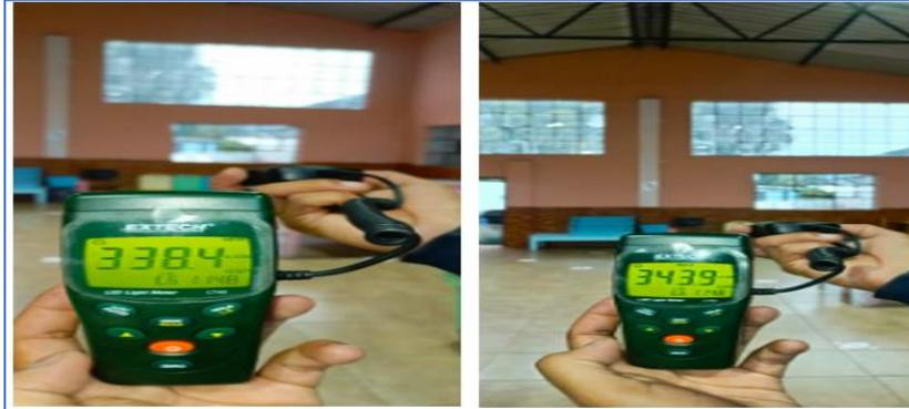
*Figura 50* Medición de luxes en el área sala de uso múltiple.
