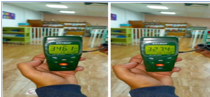
*Figura 51* Medición de luxes en el aula 2 después de la implementación.
