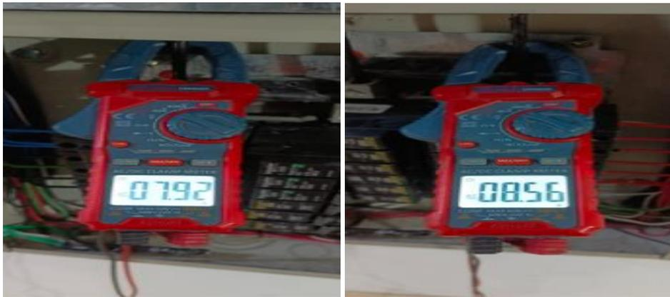
*Figura 48 Medidas de las corrientes en el tablero principal*
