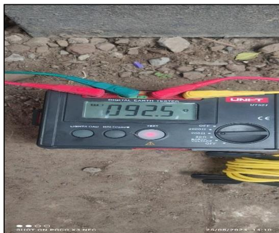
*Figura 28 Medición de la resistividad de la tierra*
