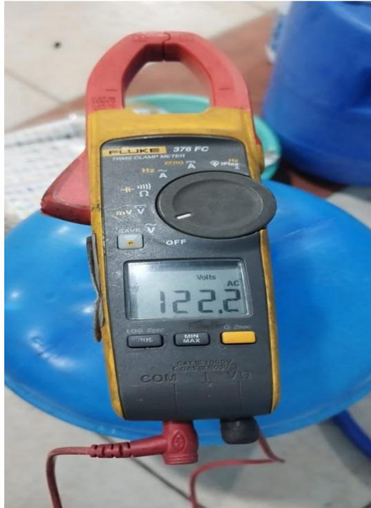
Figura 36 Voltaje de los tomacorrientes en el circuito mas alejado
