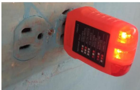
Figura 39 Verificación de tierra física en tomacorrientes
