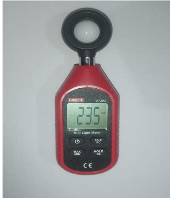
**Figura 37 Luxometro, U NI-T modelo UT383**
