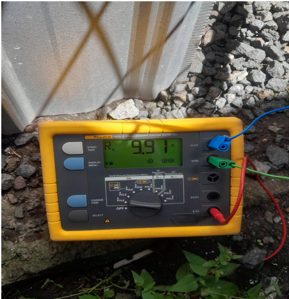
Figura 43.- Valor obtenido en el telurómetro de la medición del Electrodo. Fuente: Propia
