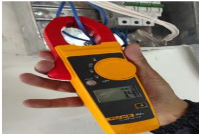
Figura 34. Verificación del centro de carga. Información tomada de Andagana. E. (2025) Elaboración propia. Quito
