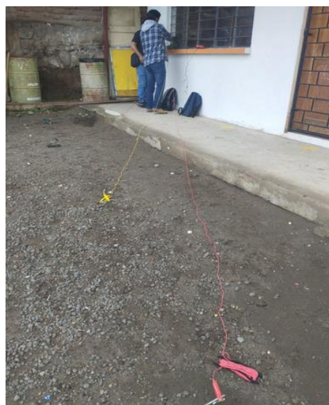
Figura 4.39. Instalación de picas para medición
