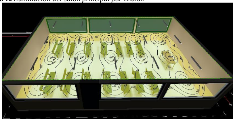
Figura 12 Iluminación del salón principal por Dialux
