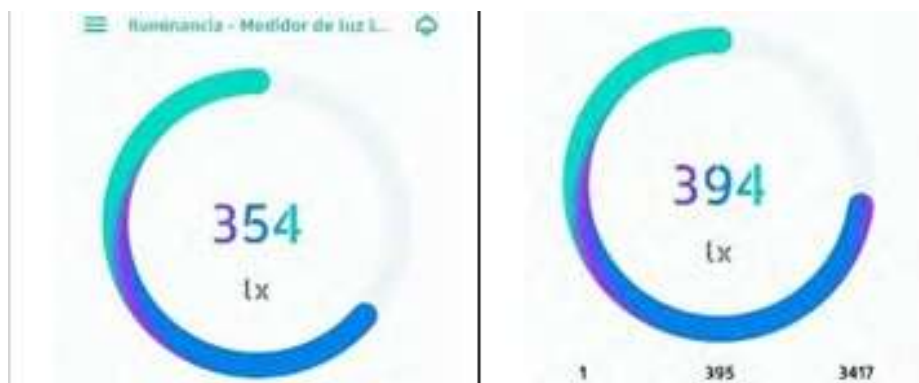
Figura 61 Prueba de iluminación en las aulas 1 y 2
