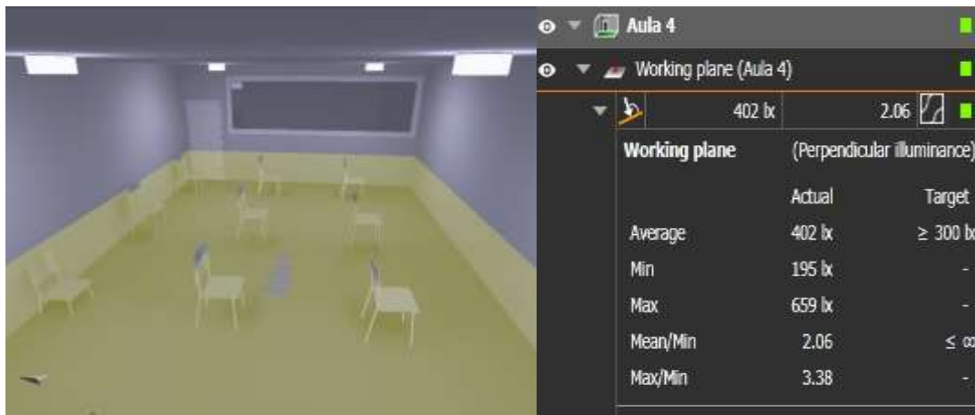
Figura 27 Simulación del aula 4 Elaborado por: autores en el Software Dialux evo
