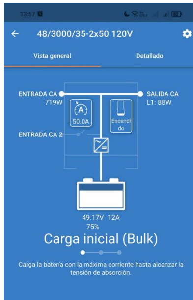
Figura 79: Interfaz con el grupo electrógeno
