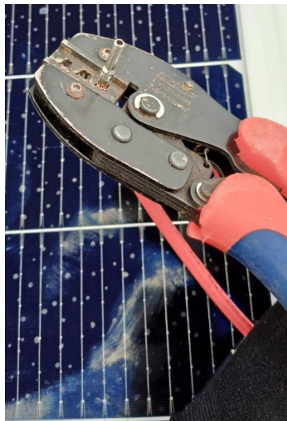
Figura 59: Inserción de conector con conductor
