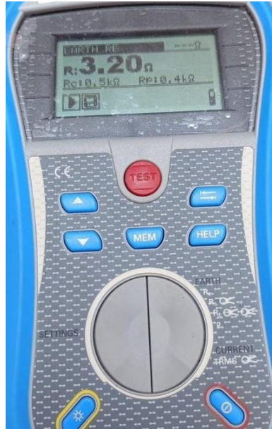
Figura 100: Segunda medición de puesta a tierra
