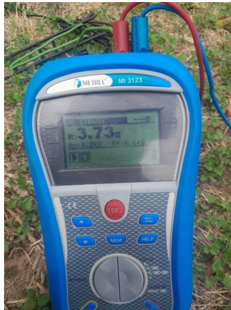
Figura 99: Primera medición de puesta a tierra
