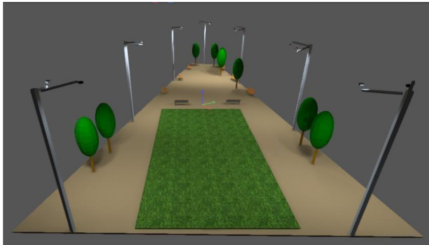
Figura 14. Diseño en Dialux de la disposición de luminarias en el parque
