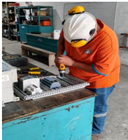
Figura 26: armado del tablero
