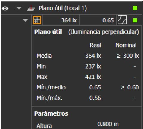
Figura 34. Resultado de la simulación de la sala de profesores Fuente: Elaboración propio (Dialux-2024)
