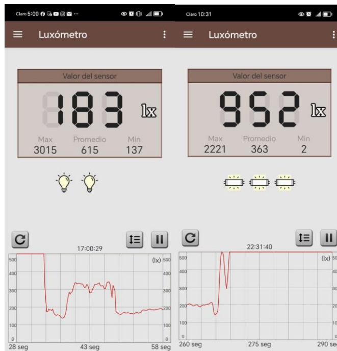
Figura 92. Medición antes y después de la instalación. Fuente: Captura de pantalla del programa luminex
