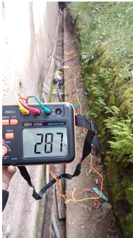
Figura 70. Medición con el Telurómetro Fuente: Elaboración propia
