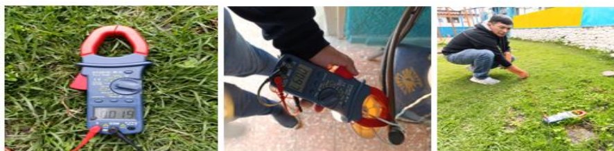
Figura 56.Comprobación a tierra
