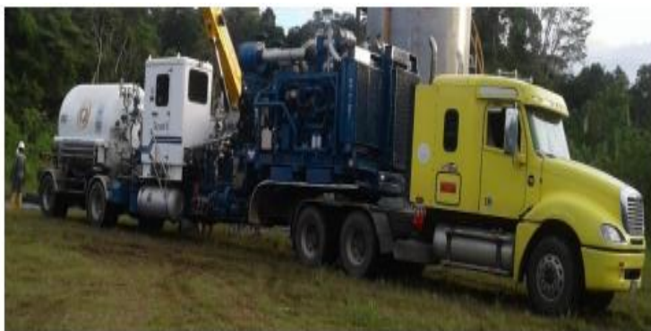
Fig.13. Unidad de bombeo de CT
