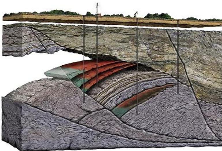
Figura 12. Estructuras permeables en los reservorios.
