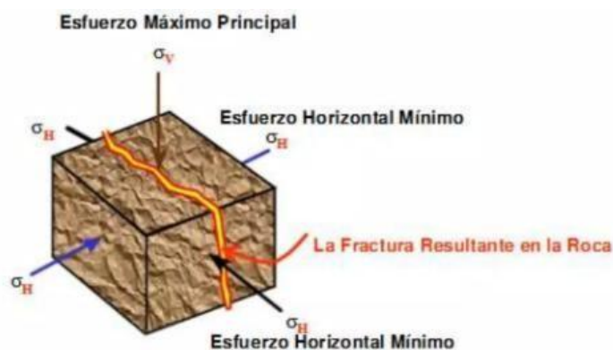
Figura 11. Diagrama de orientación de fractura Fuente. Garcia, 2020
