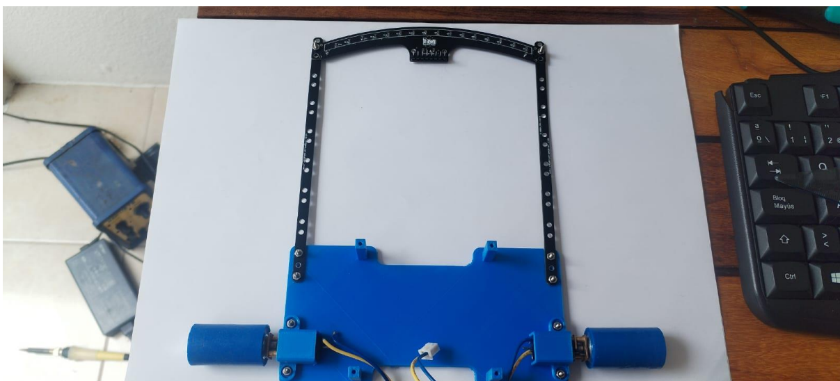
Figura 27 Regleta 16 sensores. Fuente: Propia.
