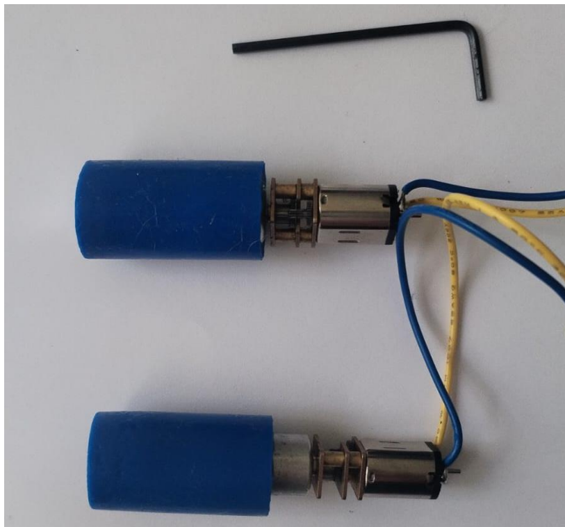
Figura 24 Micromotores Pololu, rines y gomas. Fuente: Propia.
