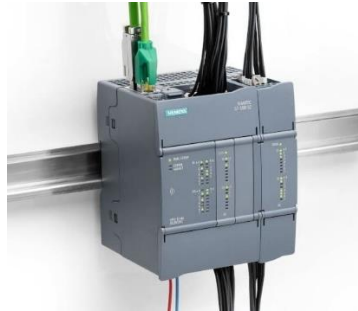
Figura 82: PLC Siemens S7-1200
