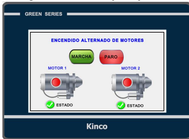
Figura 68: Interfaz HMI para la practica 3
