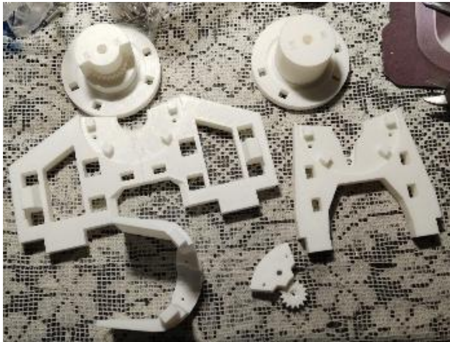
Figura 58. Estructura base de movimiento lateral.
