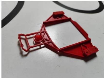
Figura 2. Modelo de Chasis impreso en 3D con PLA. Fuente: José Tapia Velásquez (2025.)
