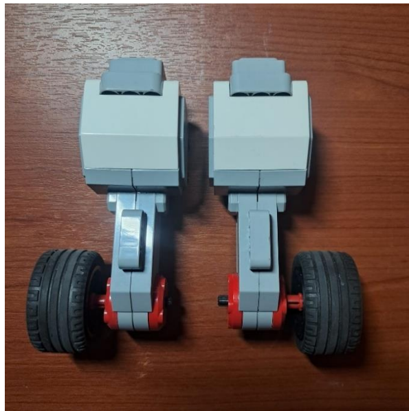
Figura 4.1 Alineación de motores y ruedas
