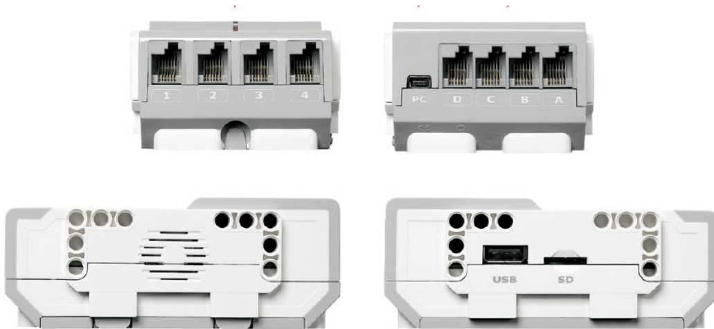
Figura 2.3 Conexiones del bloque EV3
