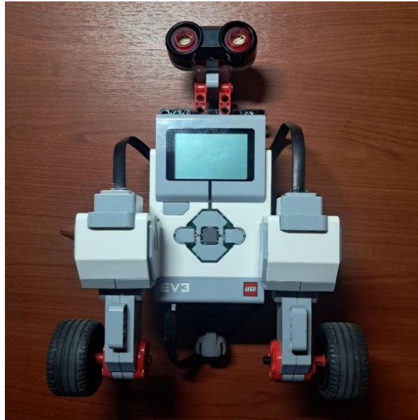
Figura 4.2 Posicionamiento de sensor ultrasónico
