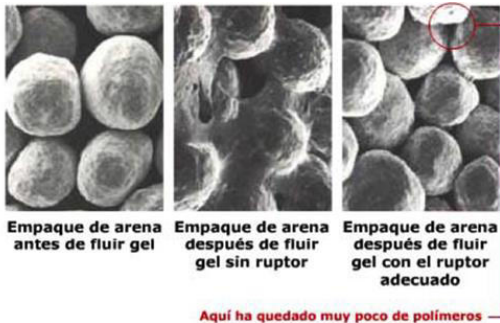
Figura 8 Geles en la fractura
