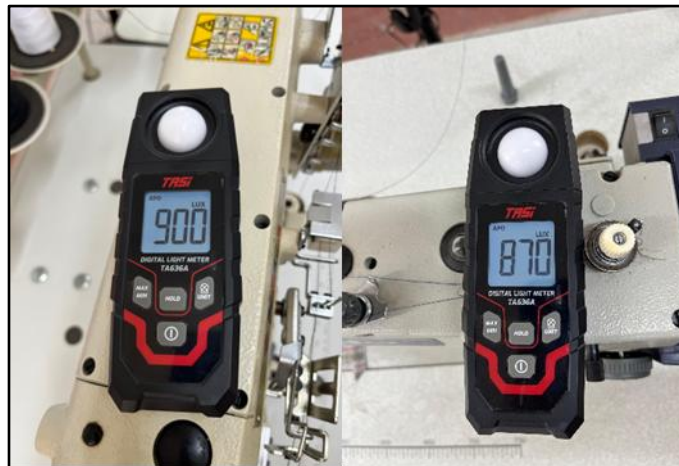
Figura 46: Medición de la Cantidad de Luxes
