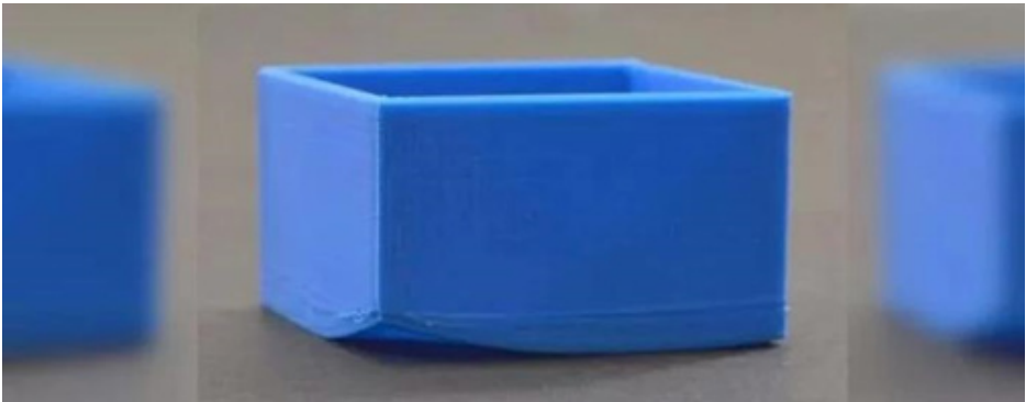
Figura 49. Fenómeno de Warping en una impresión 3D.
