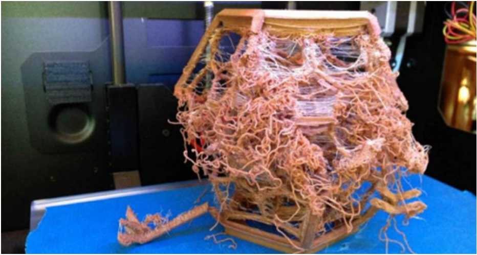
Figura 50. Error al realizar la impresión 3D.
