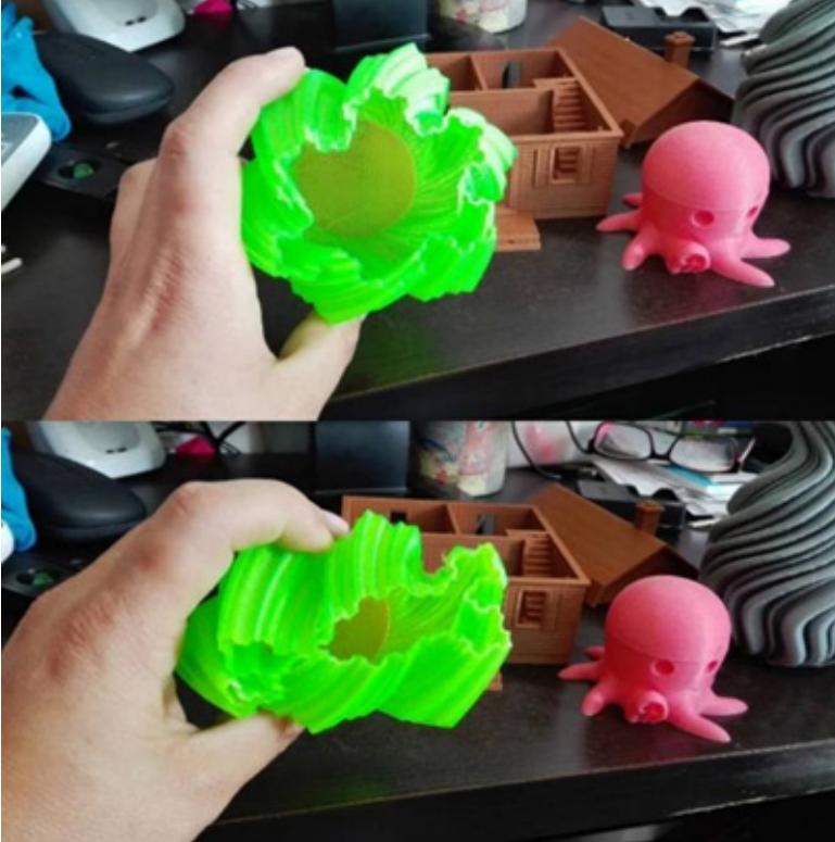
Figura 20. Ejemplo de un objeto impreso con filamento TPU.
