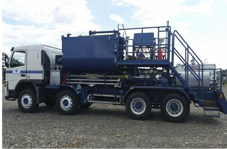
Ilustración 9. Camión bombeador típico para inyección a pozo en trabajos de limpieza química
