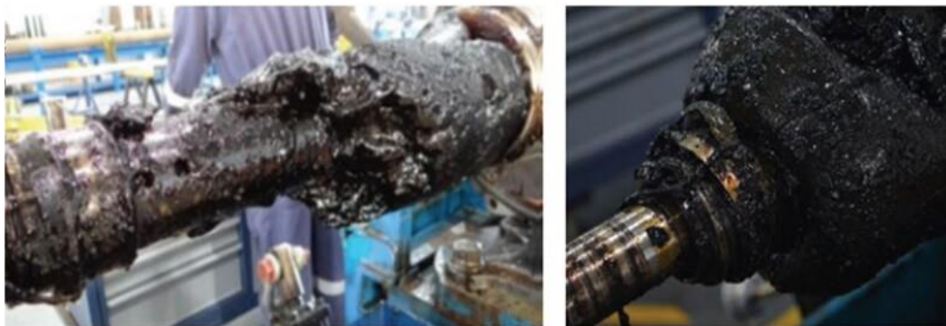
Ilustración 1. Asfaltenos depositados en sellos de la cámara del motor de una bomba electro-sumergible
