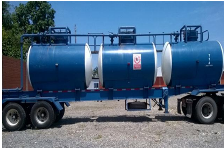
Ilustración 10. Camión cisterna típico para inyección a pozo en trabajos de limpieza química
