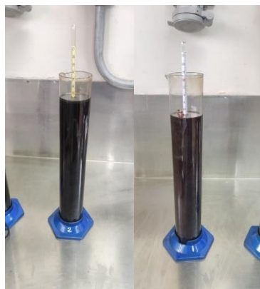
Figura 23. Toma de API Megaterio 1 y 2
