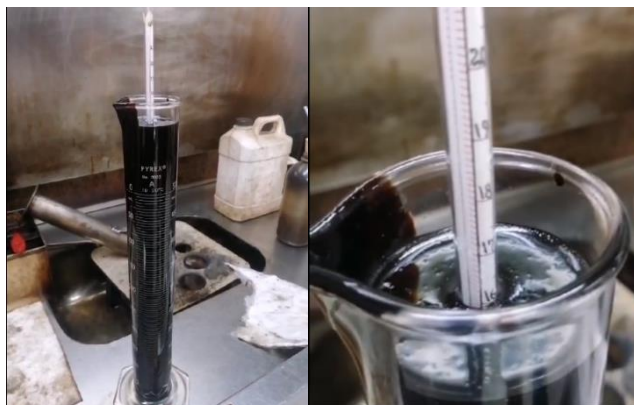
Figura 14. Toma de temperatura y API.
