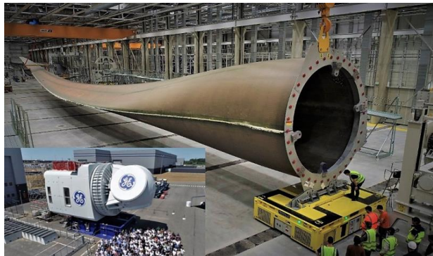
Figura 11: Parte de un aspa eólica
