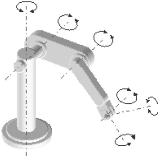
Figura 22. Brazo robótico con 6 grados de libertad.
