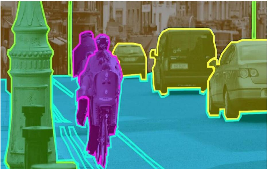
Figura 32. Proceso de reconocimiento usando segmentación somática.
