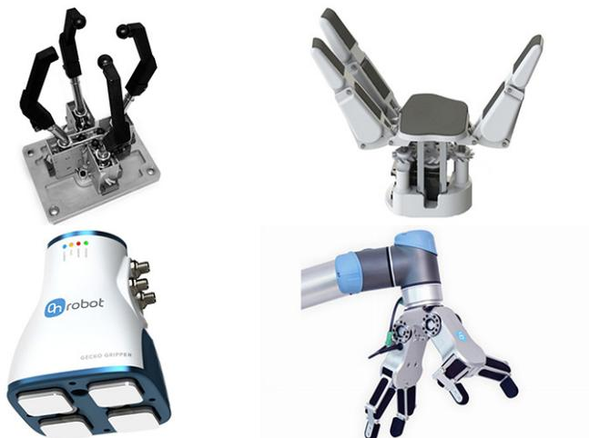
Figura 23. Diferentes efectores finales para brazos robóticos.
