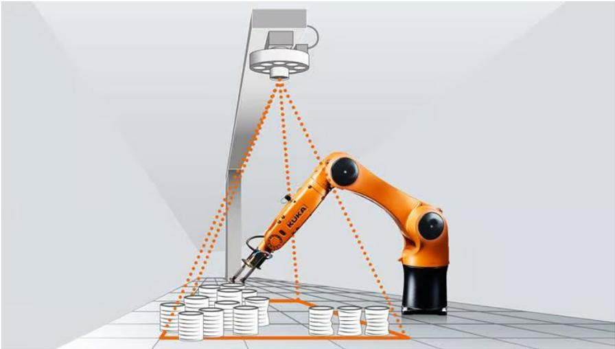
Figura 30. Brazo robótico de la marca KUKA con cámara.
