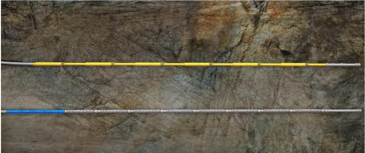
Fig.#14.- Imagen de las completaciones instaladas, en el pozo superior se instaló FCV, y en el pozo inferior instaladas las mallas.
