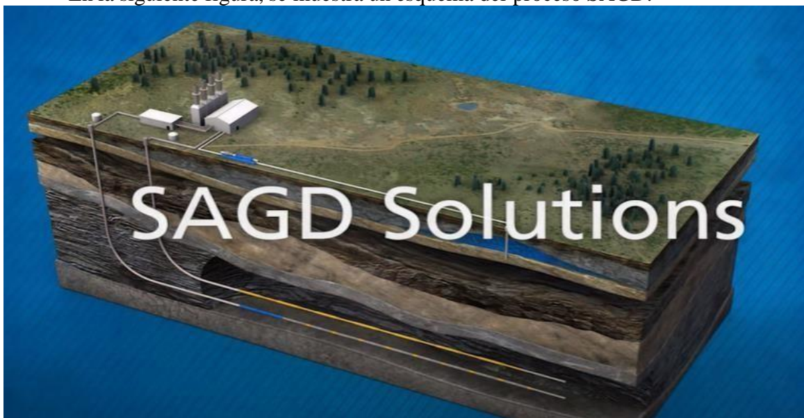
Fig #8.- Esquema básico de la perforación de los 2 pozos horizontales que se requieren para desarrollar la metodología SAGD
