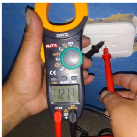
**Figura 52 Medición del voltímetro cuando se encuentra activado el circuito de tomacorrientes.**
