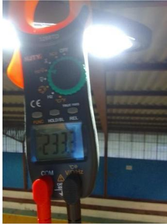
**Figura 48 Medición del voltaje con el voltímetro cuando se encuentran encendidas todas las luminarias en uno de los circuitos.**
