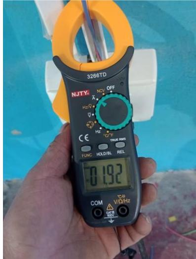
**Figura 51 Medición de la corriente tomada con el amperímetro en una luminaria al interior de los vestidores para asegurar el correcto dimensionamiento de las protecciones.**
