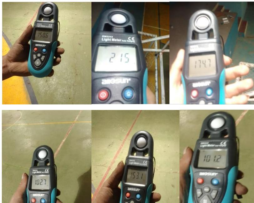
**Figura 12 Medición de luminosidad actual del coliseo con el luxómetro.**
