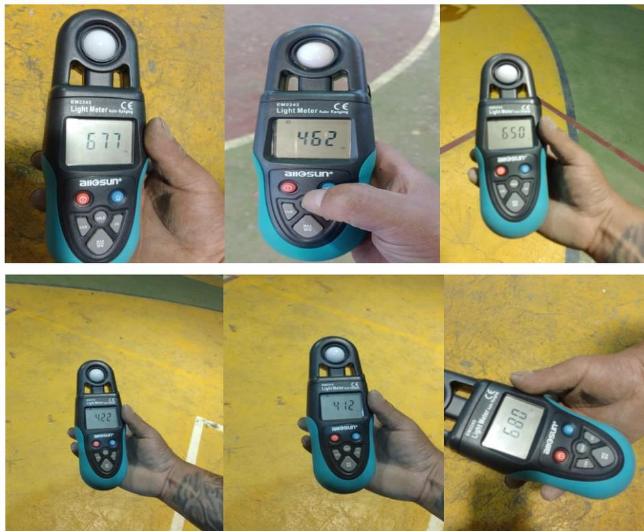
**Figura 57 Recopilación de mediciones de luminosidad final después de encender todas las luminarias dentro del coliseo.**
