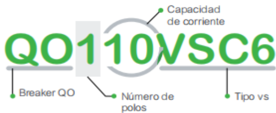
Figura 24 Descripción de protección eléctrica.
