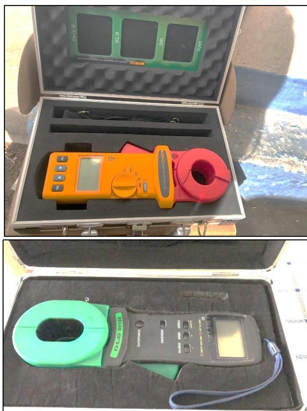
Figura 3.39 b herramientas de medición de puestas a tierra.
