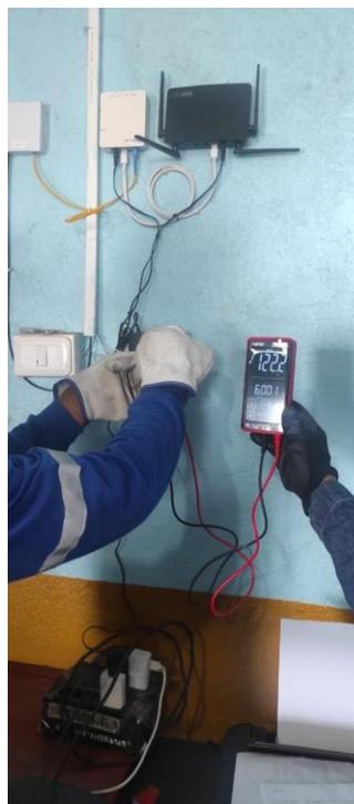
Figura 3.64. Toma de datos en el tomacorriente.
