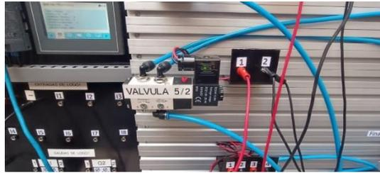
*Figura 57. Prueba de válvulas electroneumáticas
