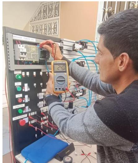
*Figura 60. Prueba de funcionamiento tablero de conexiones eléctricas
