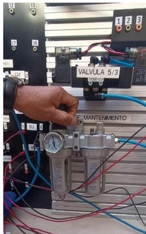
*Figura 58. Prueba de unidad de mantenimiento
