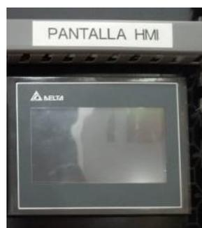
Figura 30. Pantalla HMI instalado en el módulo
