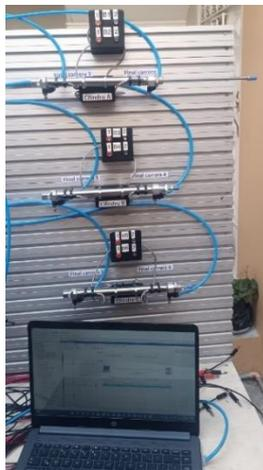
Figura 56. Prueba de cilindros neumáticos
