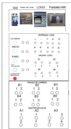
Figura 40. Tablero de control eléctrico
