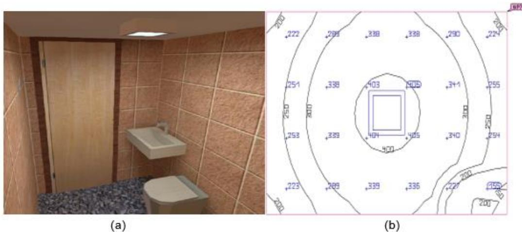
**Figura 23.** Simulación estado final y escenas de luz del baño 1
