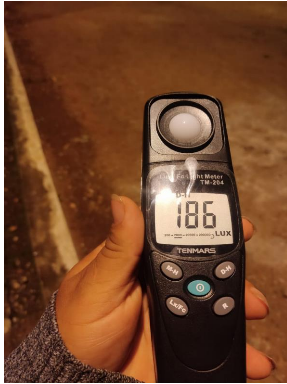
Figura 55. Niveles de luminosidad al exterior.
