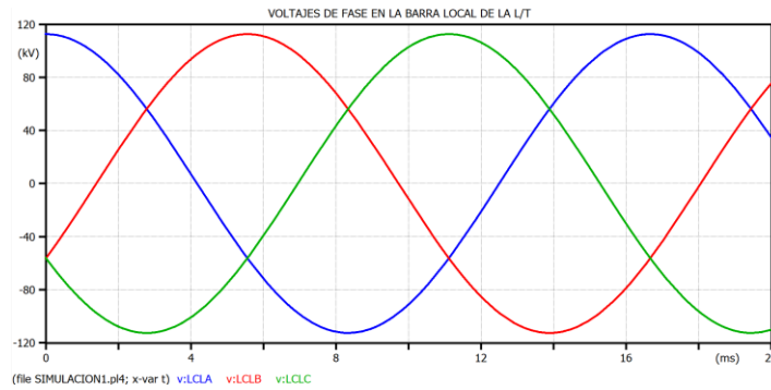
Figura 5. Voltajes de fase en la barra local de la L/T
